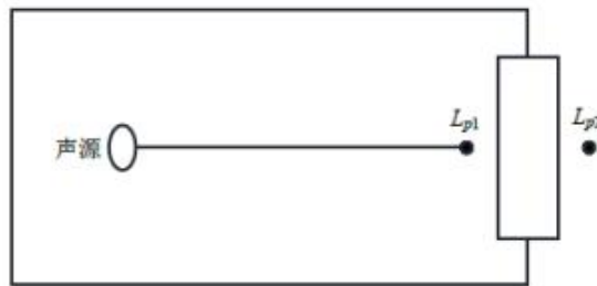
图 8.2-1 室内声源等效为室外声源图例
