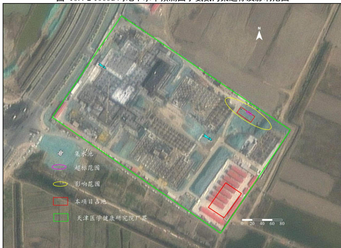
图 10.4-3 7300d 时地下水中预测因子氨氮污染超标及影响范围
