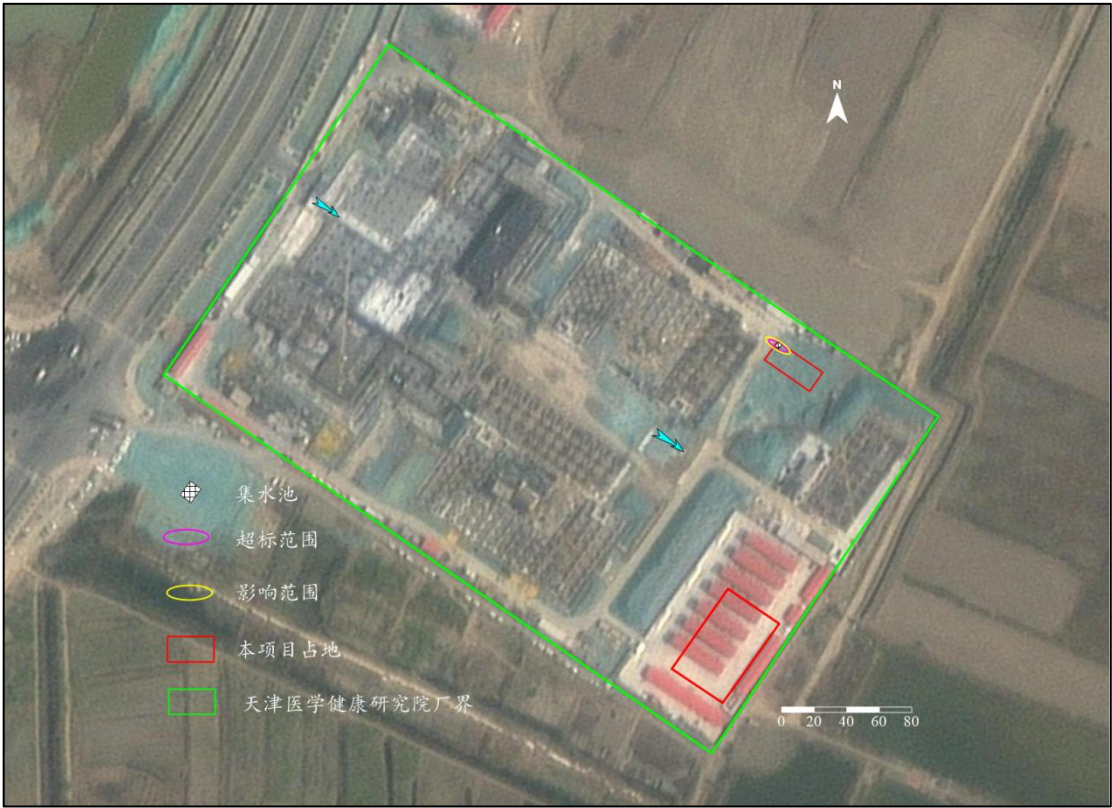
图 10.4-1 100d 时地下水中预测因子氨氮污染超标及影响范围
