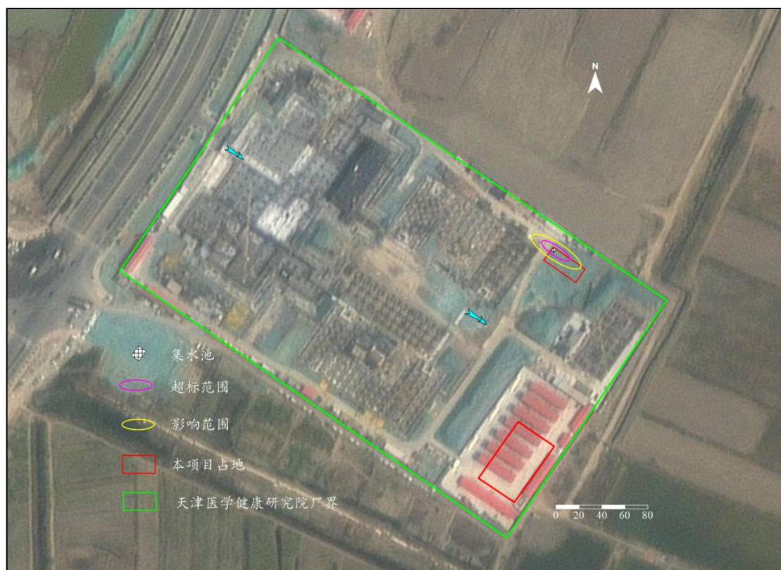
图 10.4-2 1000d 时地下水中预测因子氨氮污染超标及影响范围
