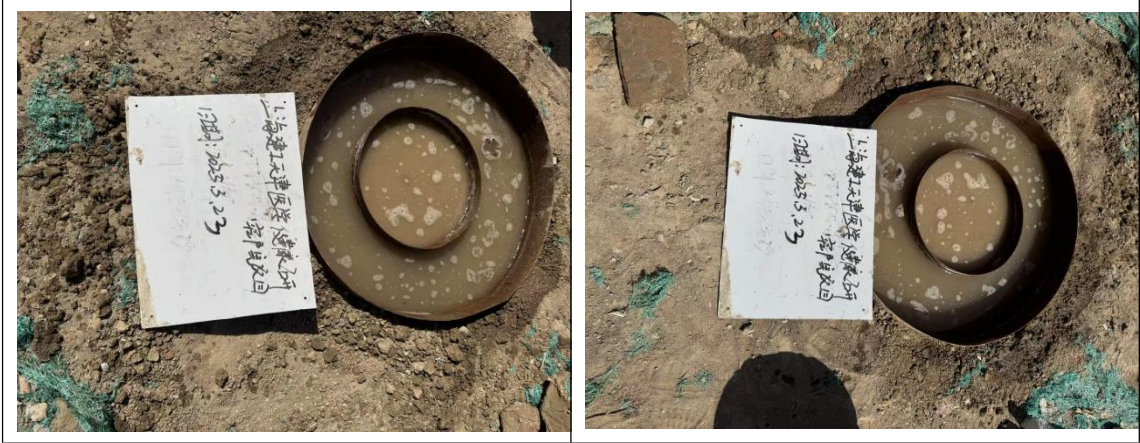
图 4.5-8 现场双环渗水试验过程
