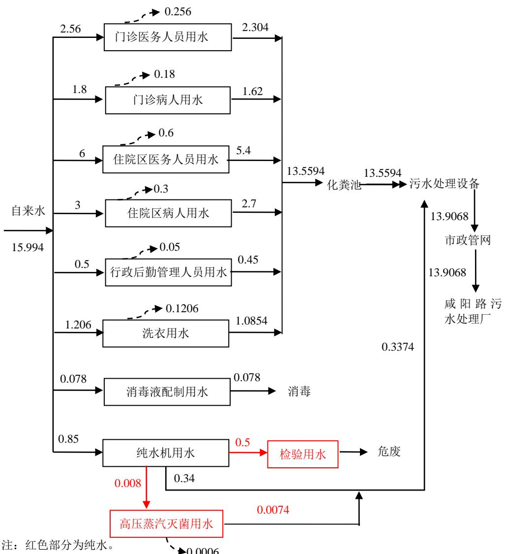
图 2-1 本项目水平衡图 (按最大日用水量计) 单位 m³/d
