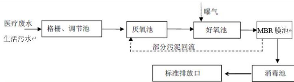
图 4-1 本项目废水处理工艺流程图
