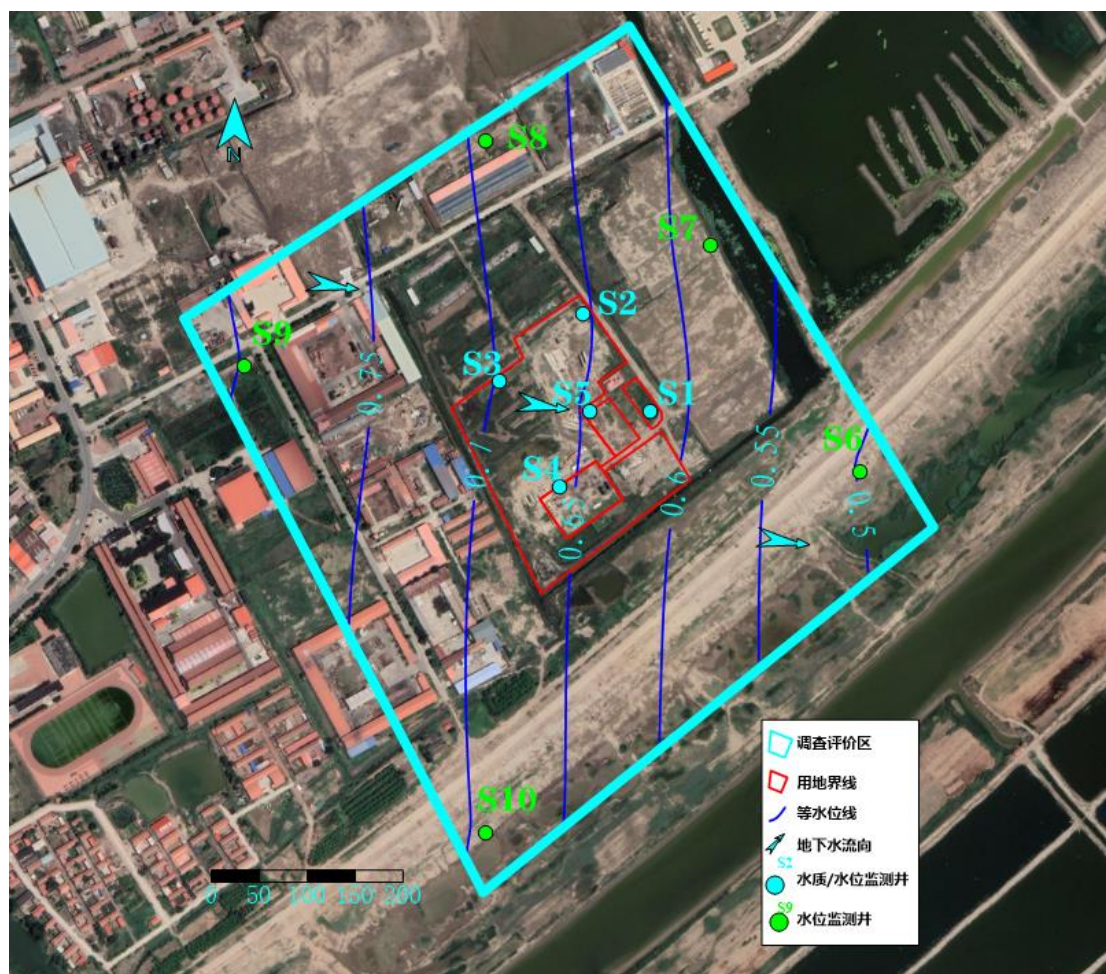
图 5.4-2 建设项目调查评价区地下水位等值线及流向图
